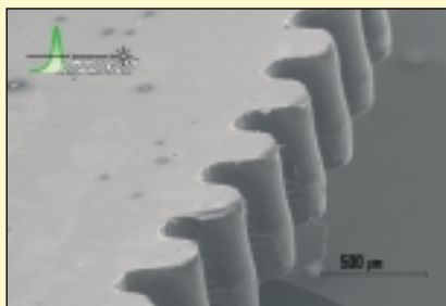
Engrenage taillé au laser femtoseconde par Impulsions SAS. Source : Impulsions SAS
